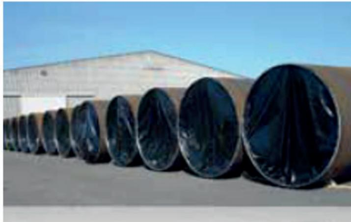
Figura 7. Mantas de PVC para la protección de los extremos en conjunto con protectores metálicos en los extremos.
