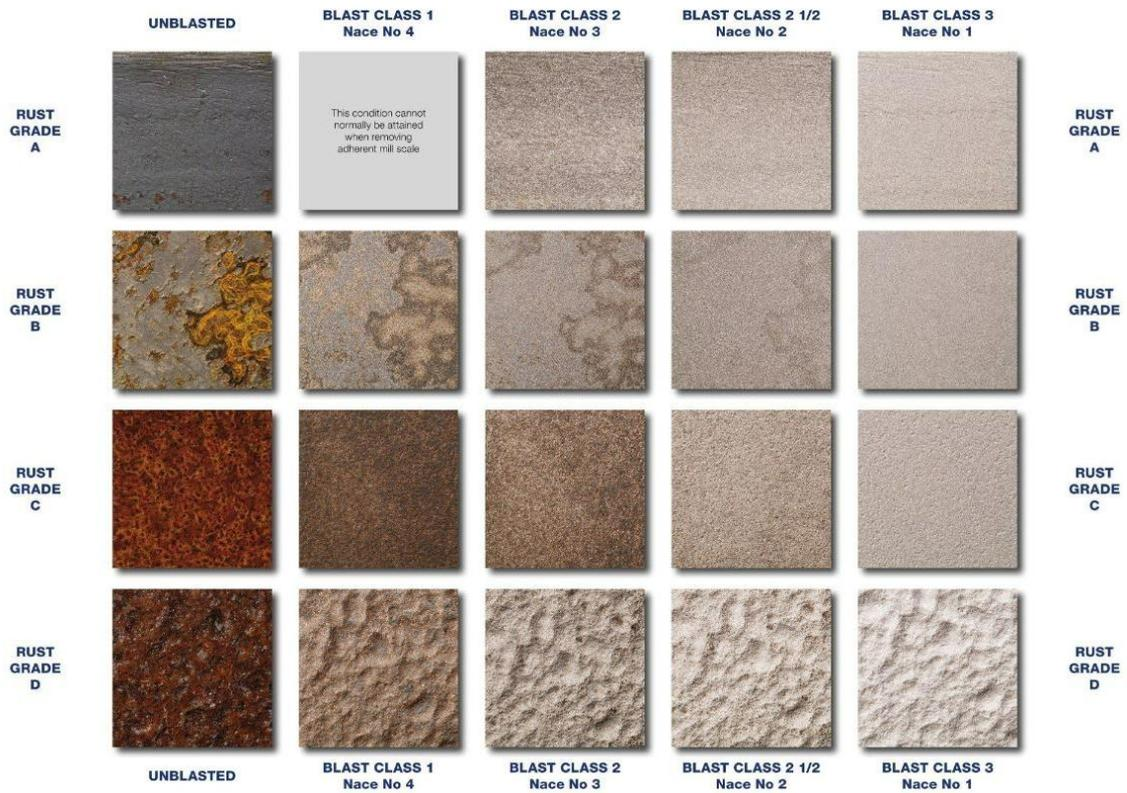
Figura 2: Distintos grados de limpieza superficial del acero dependiendo del tipo de óxido inicial.
