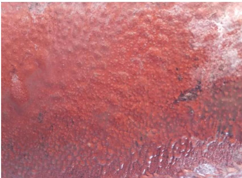
*Figura 11: Superficie revestida con espesor insuficiente de epoxi. Se observan además chorreaduras y ampollas.*
