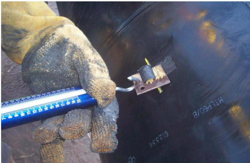
Figura 26: Ensayo de adherencia con dinamómetro.
