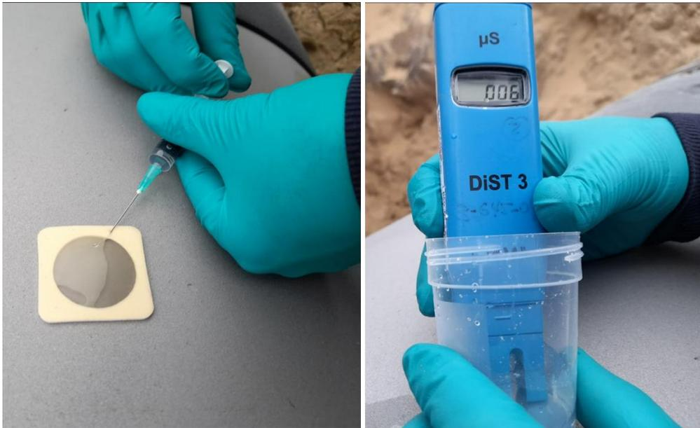
*Figura 9: Medición de sales en superficie arenada por método de Bresle.*
