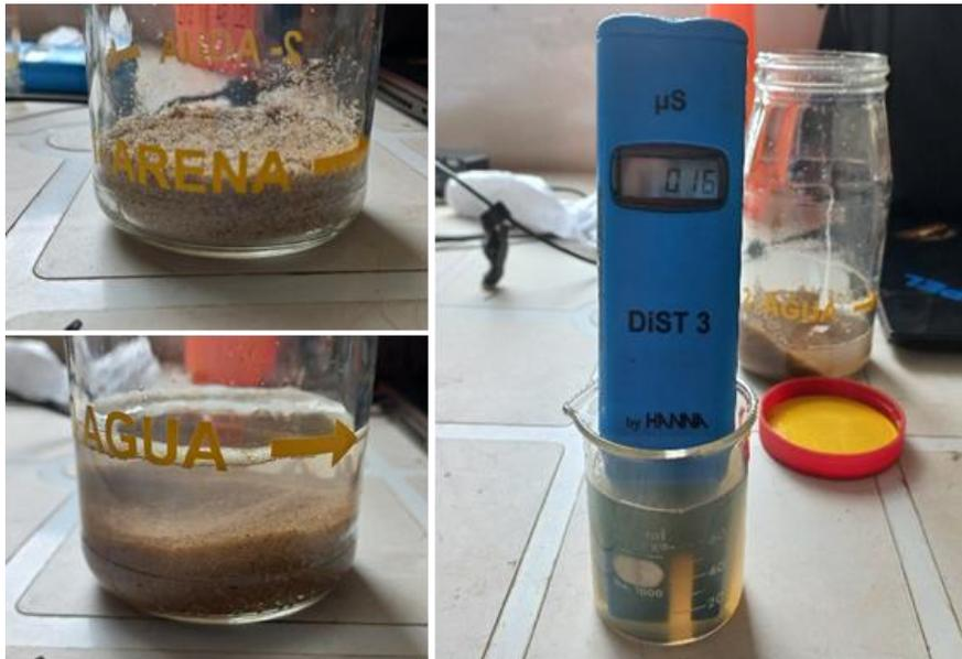
Figura 4: Control de especies iónicas solubles en agua en arena para limpieza abrasiva.
