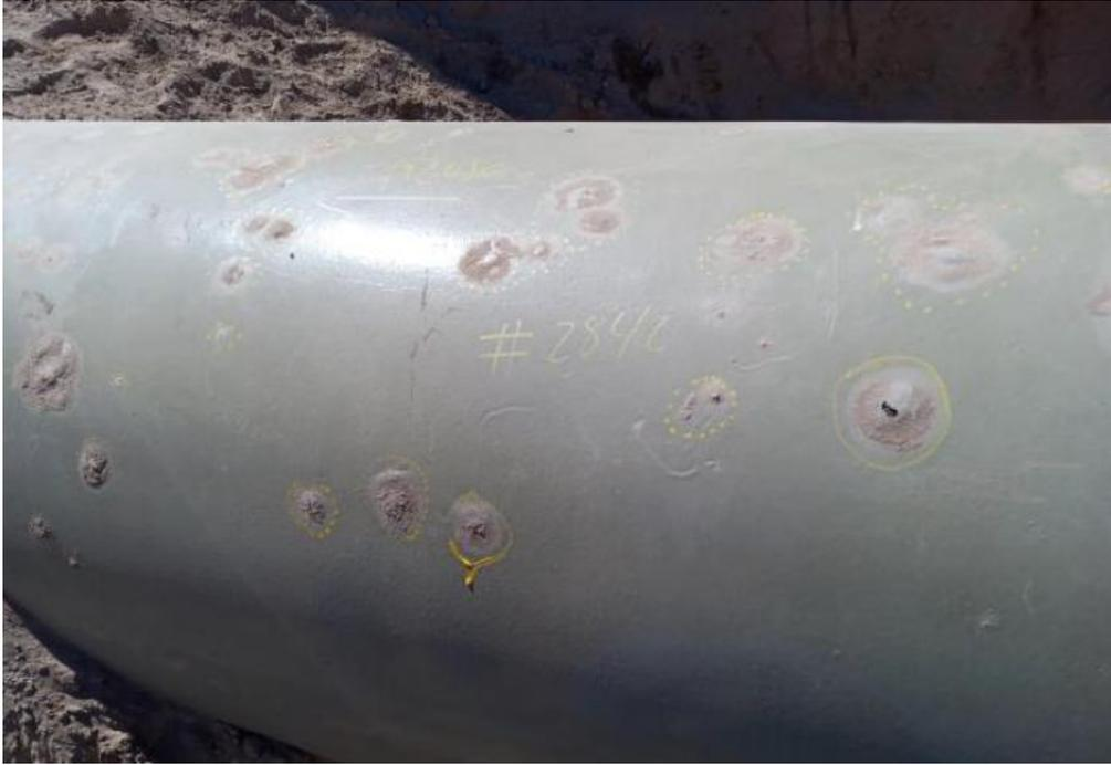
*Figura 8: Ampollas en ducto revestido con pintura epoxi.*
