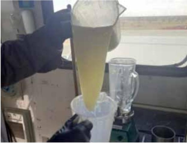
Figura 16. Muestra del gel de fractura obtenida durante el bombeo del colchón.
