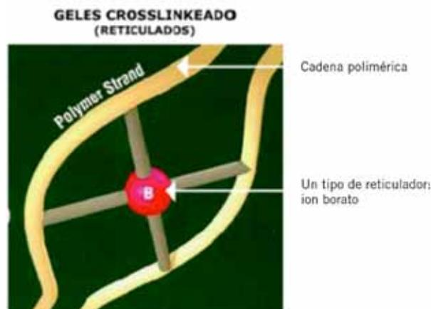
Figura 9. Reticulado de gel crosslinkado (3)
