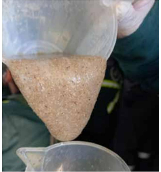
Figura 19. Muestra del gel de fractura durante las concentraciones de arena.
