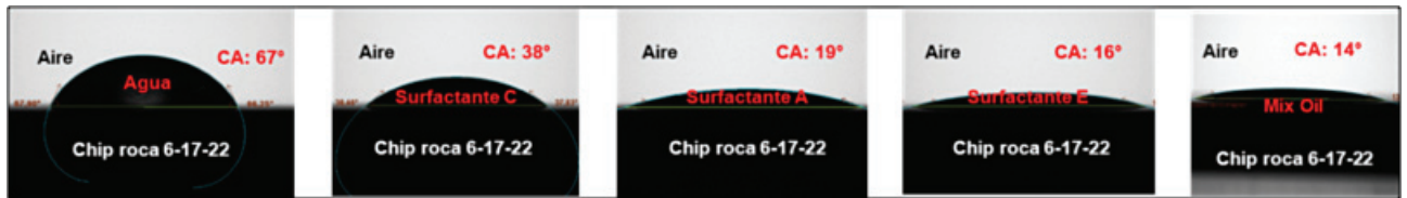
Figura 9. Angulo de contacto de fluidos sobre substrato solido 6-17-22.
