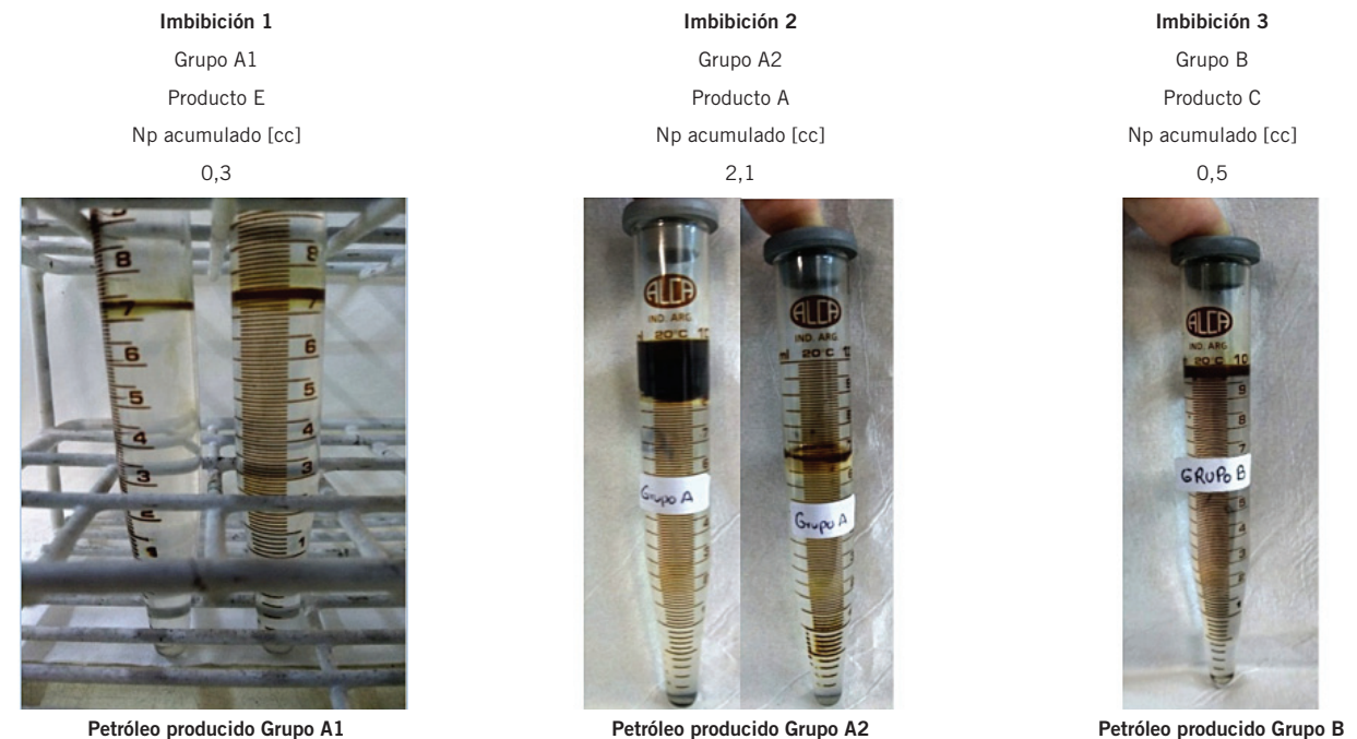
Figura 10. Resultados de las 3 pruebas de imbibición @ 100°C.
