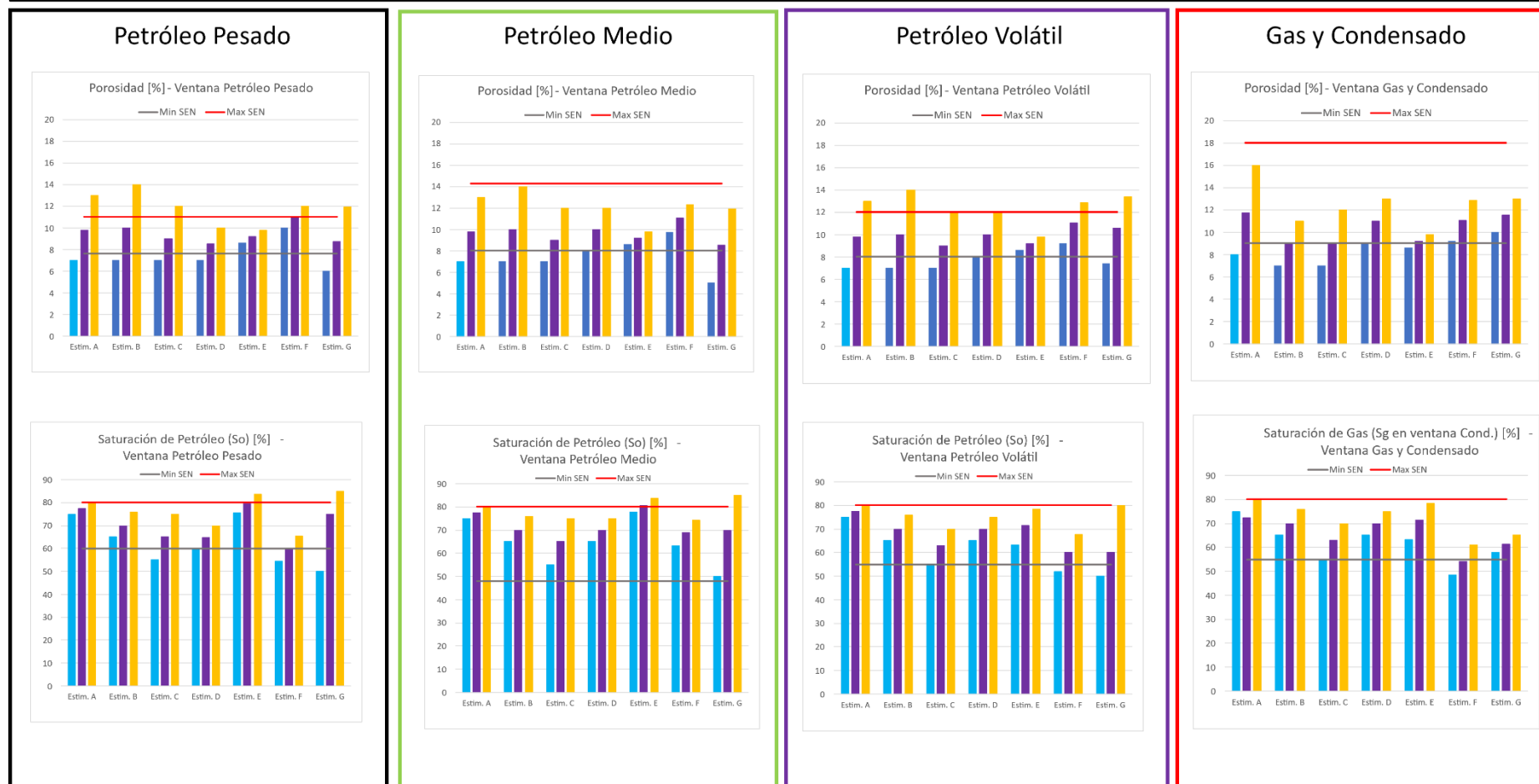
Figura 18: Comparación entre los parámetros de la roca (porosidad, saturación de gas, saturación de petróleo) utilizados en las estimaciones independientes y los datos compilados por SEN y/u obtenidos de la bibliografía.
