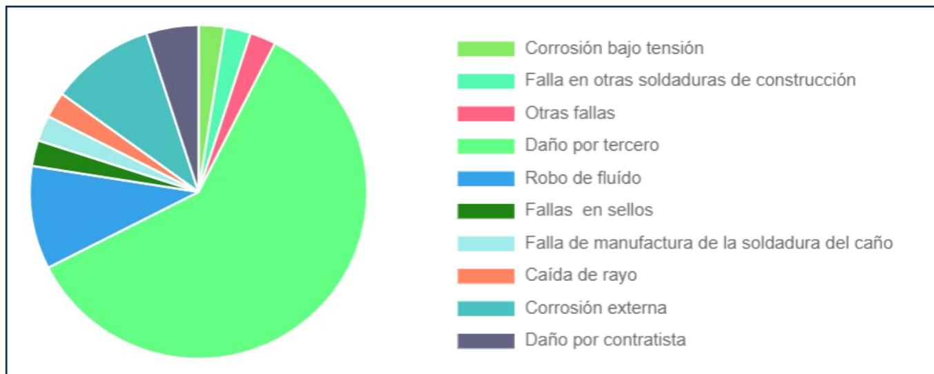
Figura 20 – Distribución de Incidentes por sub-causa para tamaño de orificio de fuga de 2 mm a <110 mm para el período 2009-2023
